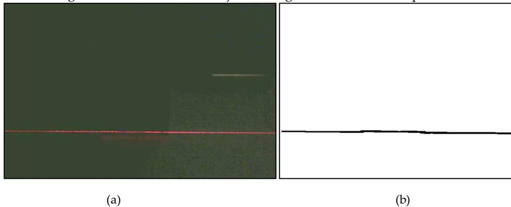
Gambar 1. *Line laser* dengan berbagai kondisi: (a) Sinar *line laser* saat tidak ada halangan di depan kursi roda; dan (b) Hasil segmentasi sinar *line laser*.
